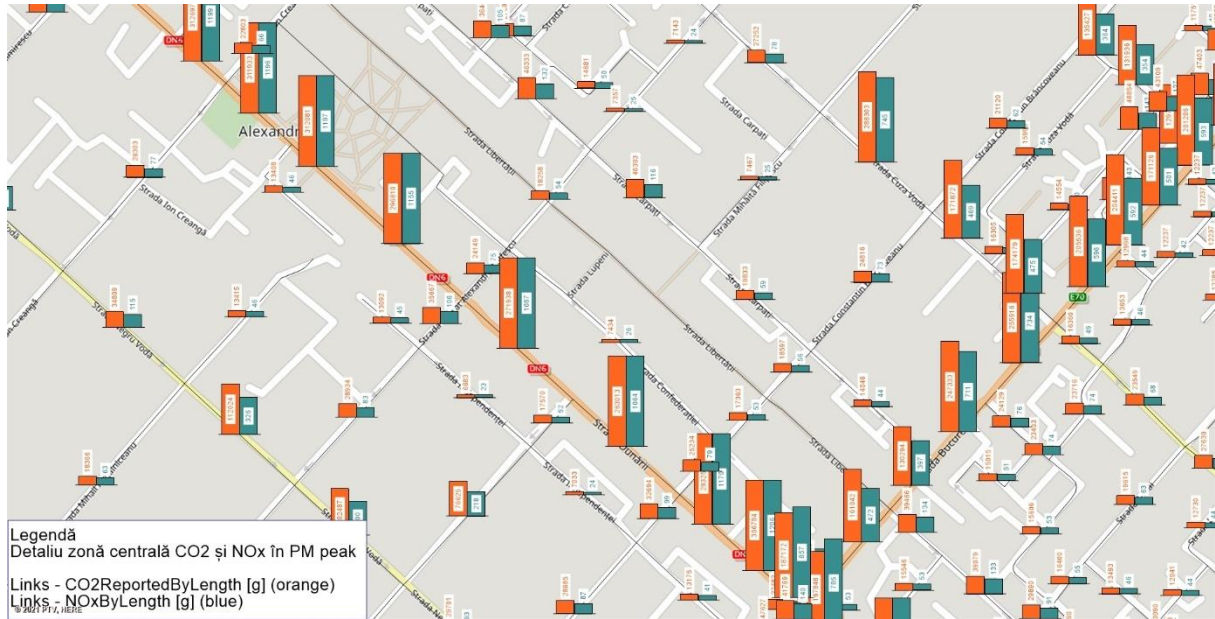
Fig. I.3. 46 - CO 2 și NO x pe segmente, PM peak - detaliu zona centrală
