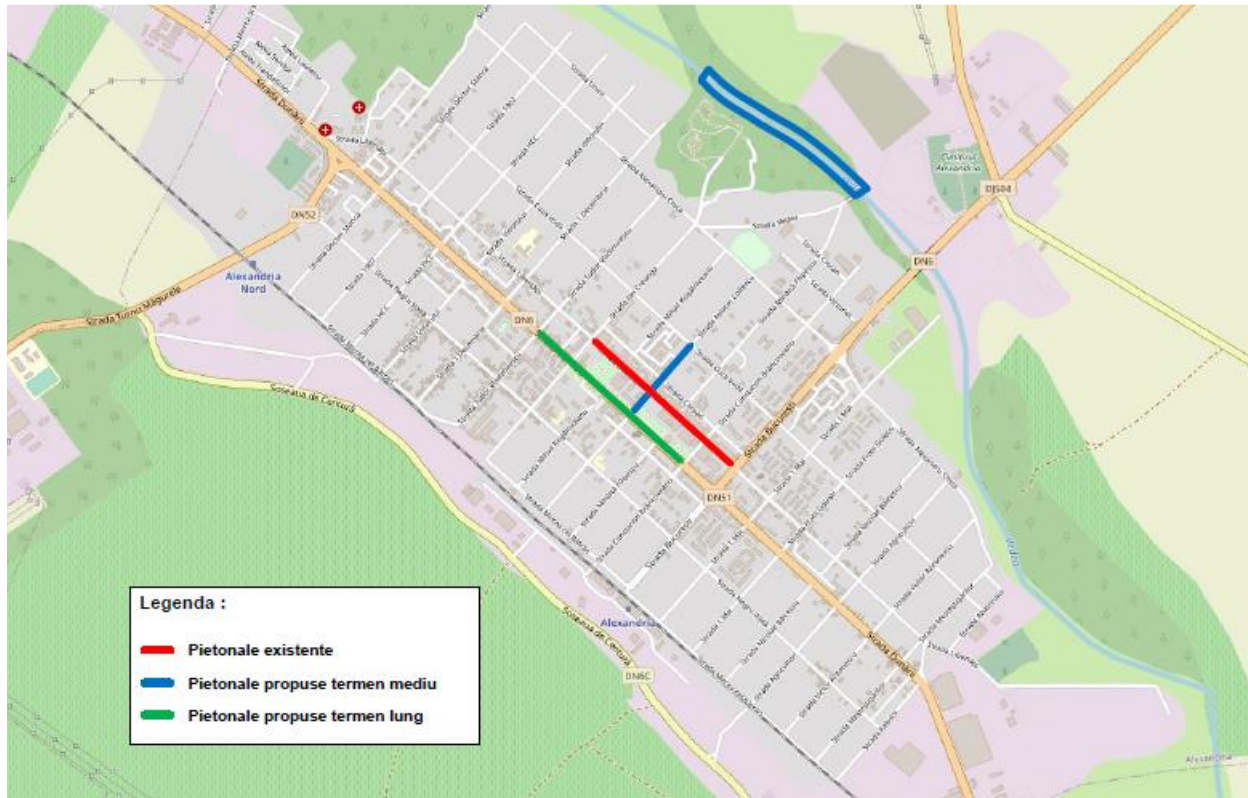
Fig. I.8. 1 - Zone pietonale propuse
